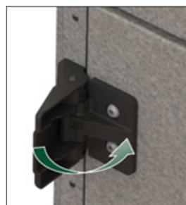
Scharniere mit Druckentlastung; so konstruiert, dass eine Beschädigung der Dichtung der Wartungstür durch Scherkräfte vermieden wird
